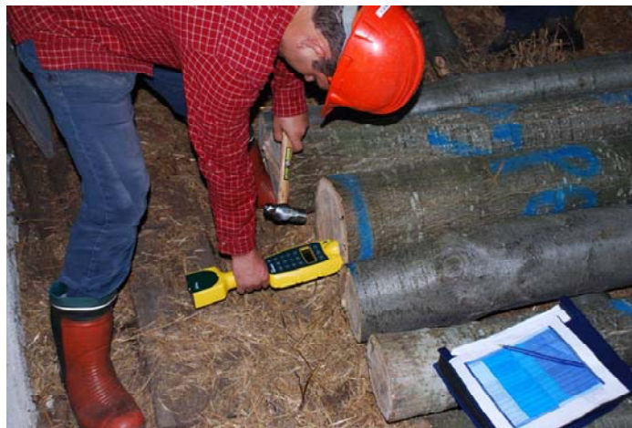
Figure 2 - Prise de mesure acoustique sur une bille à l’aide de l’outil HM 200 2
