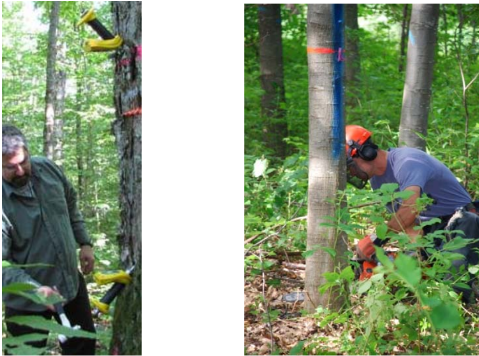
Figure 1 – L’instrument acoustique I ML Hammer 1 et abattage d’un chêne rouge
